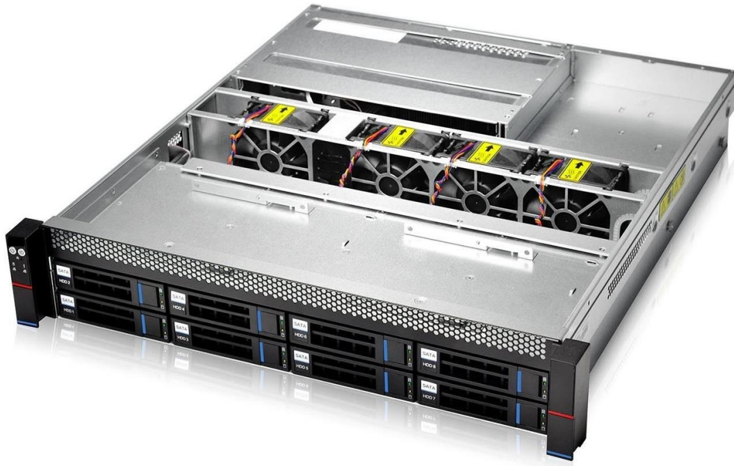
Рисунок 2. Серверная платформа QSRV-230804 (вид сверху)
