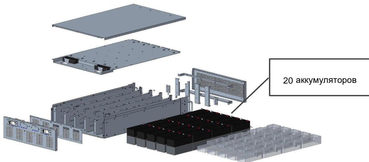
Рисунок 4. Установка 20 аккумуляторных батарей
