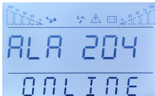
Рисунок 25. Пример отображения предупреждения на дисплее ИБП
