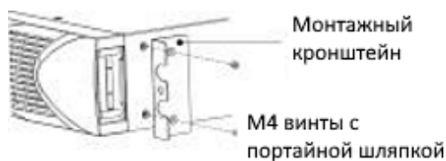
Рисунок 6. Установка монтажных кронштейнов
