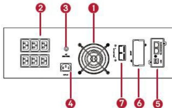
Рисунок 2. Вид задней панели ИБП 1500 В·А – 3000 В·А
