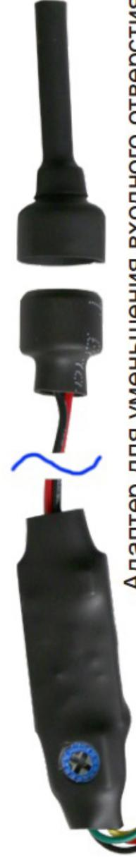
Адаптер для уменьшения входного отверстия микрофона до 3мм. Позволяет обеспечить скрытную установку. При необходимости, зафиксируйте место соединения изолентой. Провода между капсулем и усилителем можно незначительно удлинить.
