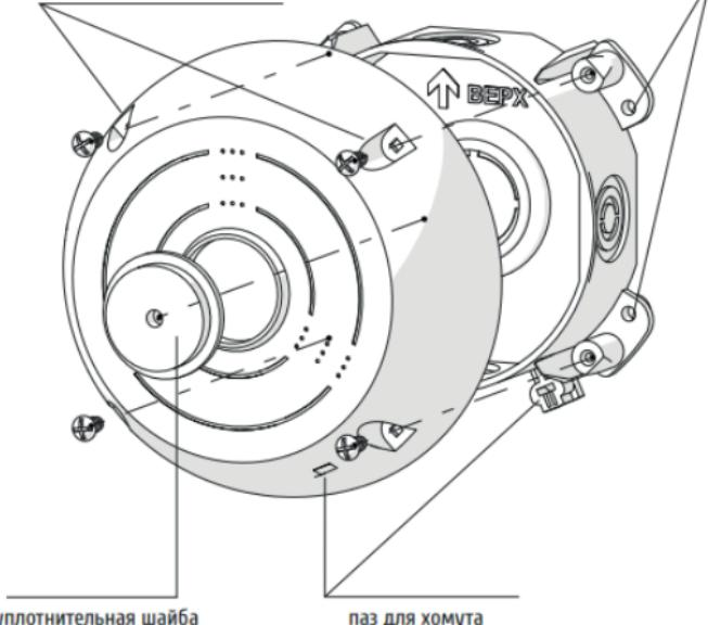
3) Смонтируйте видеокамеру на крышку монтажной коробки, затем заведите все приходящие провода и разместите их в полости основания коробки.
