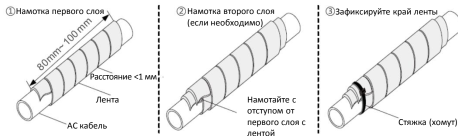
Рисунок 5.18 – Намотка уплотнительной ленты
