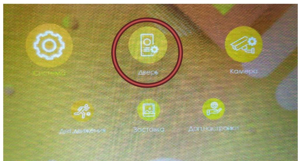
В разделе «Дверь» с помощью кнопок выбора выберите канал «Дверь 1» или «Дверь 2» (Панель 1 или Панель 2), в зависимости от того, через какой канал будет подключена панель DSH-1080/1-2-3-4.
