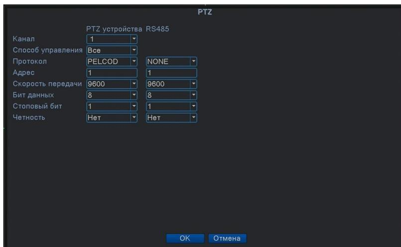
Рисунок 4.36 Конфигурация PTZ и RS485 устройств в аналоговом и гибридном режимах.
