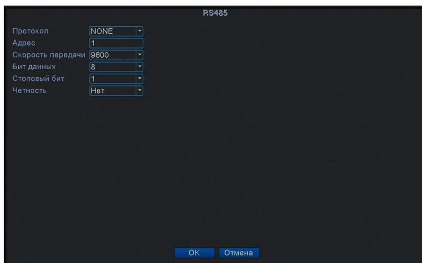
Рисунок 4.37 Конфигурация RS485 устройств в цифровом режиме.
