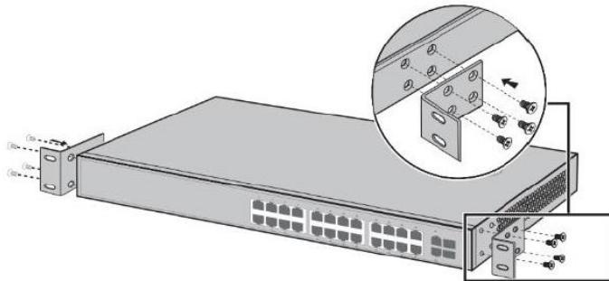
Затем закрепите коммутатор в стойке.
