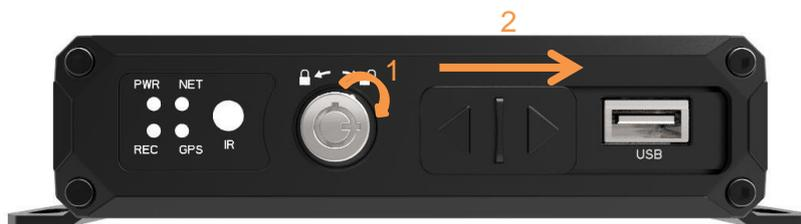
Для Optimus MDVR-2041E 4G/GLONASS: Откройте замок комплектным ключом, извлеките отсек для диска и установите карту памяти в слот под ним. Открутите фиксирующие винты крышки дискового кейса, установите на диск виброгасители и подключите его к кейсу. Поместите диск вовнутрь, закройте крышку кейса и зафиксируйте её винтами. Установите дисковый отсек в устройство и закройте замок.
