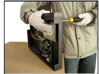
3. закрутите винты HDD
