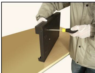
4. закрутите винты HDD
