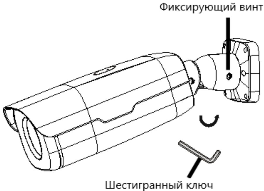
После затяжки винта поворачивать камеру на шарнире нельзя.
