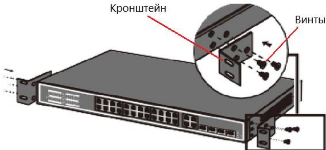
2) Прикрутить устройство с помощью кронштейнов к стойке плавающими болтами, как показано на следующем рисунке:
