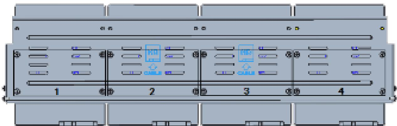
5. Установите монтажное основание с HDD-диск на место. Подключите кабели питания и кабели передачи данных, как показано на рисунке:
