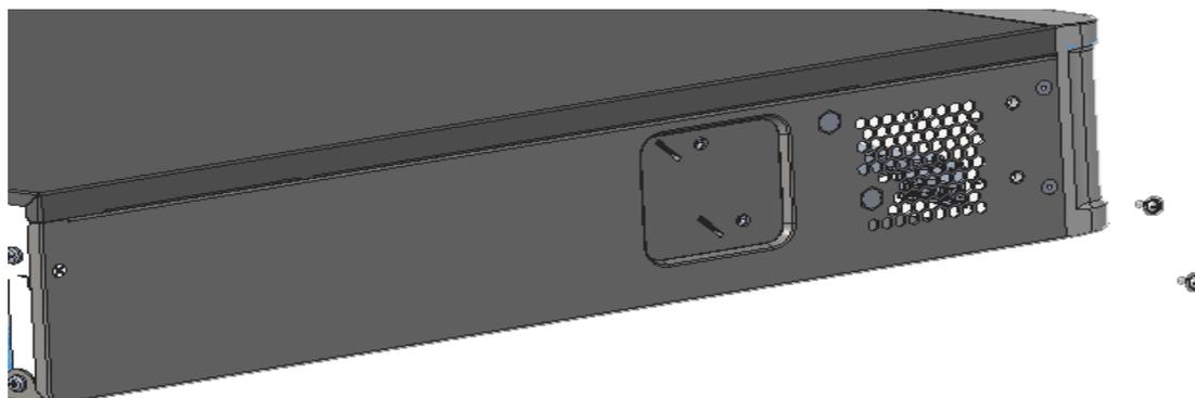
2. Поверните верхнюю панель монтажного основания, как показано на рисунке и снимите её:
