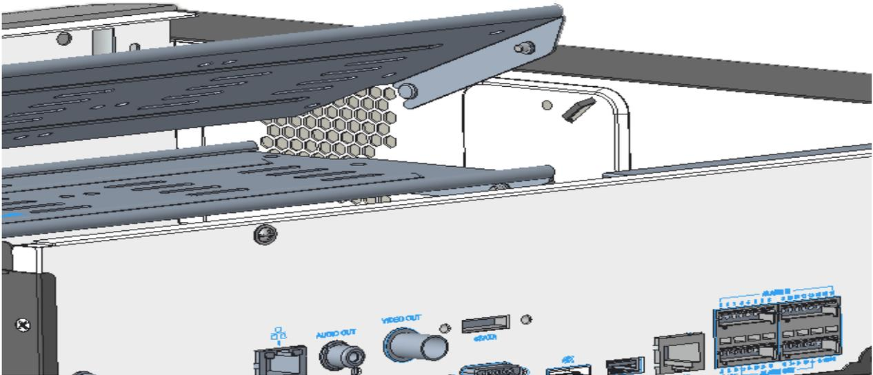
3. Аналогичным образом снимите нижнюю панель монтажного основания.
