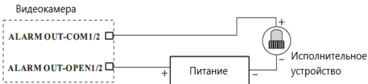
Рисунок 4 – Подключение исполнительного устройства к тревожному выходу
