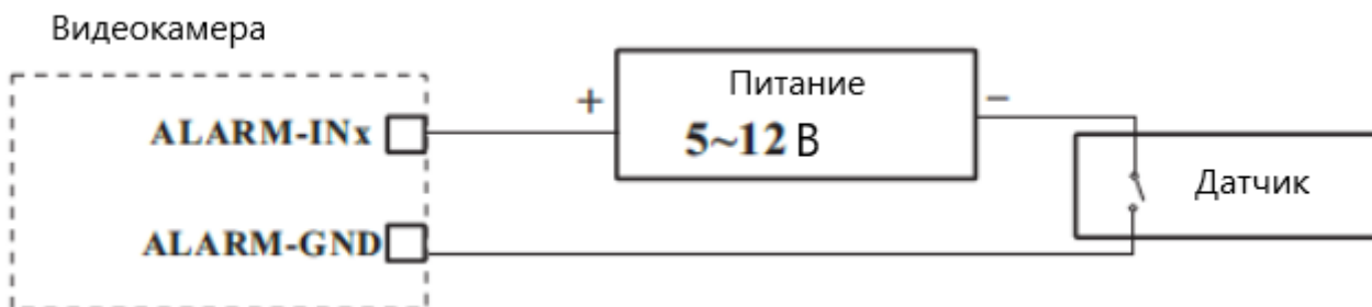
Рисунок 3 – Подключение датчика к тревожному входу
