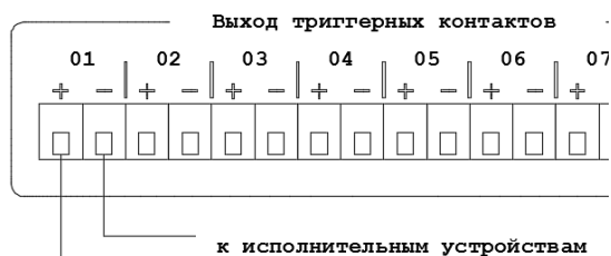
Рис. 3.5. Схема подключения внешних исполнительных устройств к LPA-PRESTA-2.
