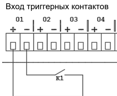
Рис. 3.4. Схема подключения внешних сигналов управления к LPA-PRESTA-2 без контроля целостности.
