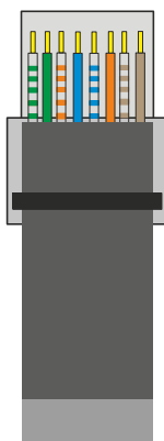
Рис. 4.1. Разводка проводов по стандарту EIA/TIA 568A
