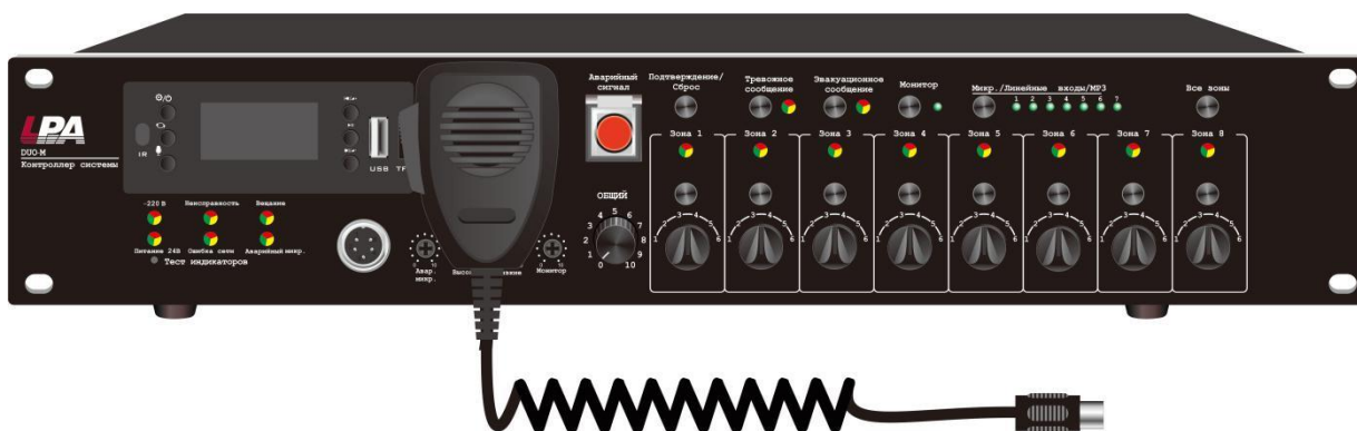
Рис. 1.1. Контроллер системы оповещения LPA-DUO-M (передняя панель)
