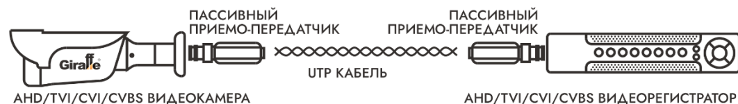
Рис. 1 Схема включения пассивного приемопередатчика.
