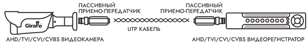
Рис. 1 Схема включения пассивного приемопередатчика.
