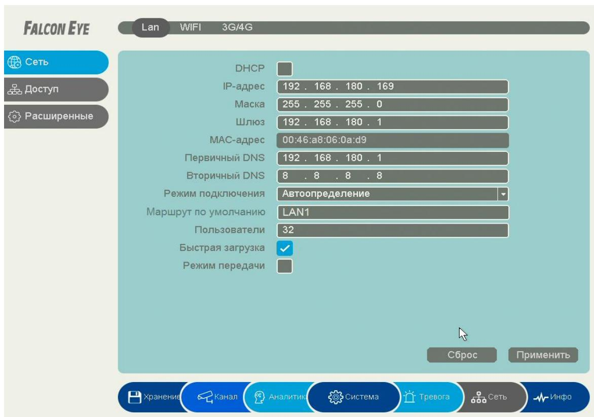
Можно задать получение адреса регистратором от DHCP (при этом необходимо, чтобы сервер DHCP был в сети) сервера при установке параметра **DHCP**, либо вручную.
