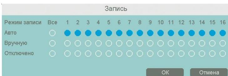
Для включения записи вручную необходимо выбрать **Вручную** и нажать **OK**. Для отключения записи нужно выбрать **Отключено** и нажать **OK**, при этом запись производится не будет. Для записи по расписанию (и тревогам) необходимо выбрать **Авто**.
