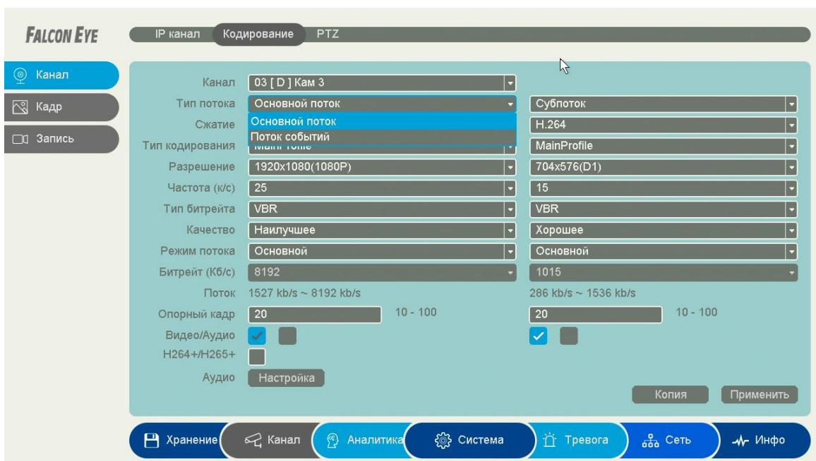
Регистратор позволяет настроить запись видео следующим образом: при непрерывной записи запись осуществляется с одним количеством кадров в секунду (например, 1-5 кадров в секунду), а при возникновении любого тревожного события (срабатывания детектора движения, детектора видеоаналитики и т.д.) запись осуществляется с другим количеством кадров в секунду (например, 25 кадров в секунду).
