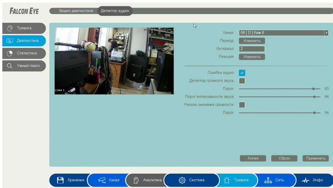
**Ошибка аудио** – включение режима при котором срабатывает тревога при нарушении аудио канала, например при обрыве питания микрофона.
