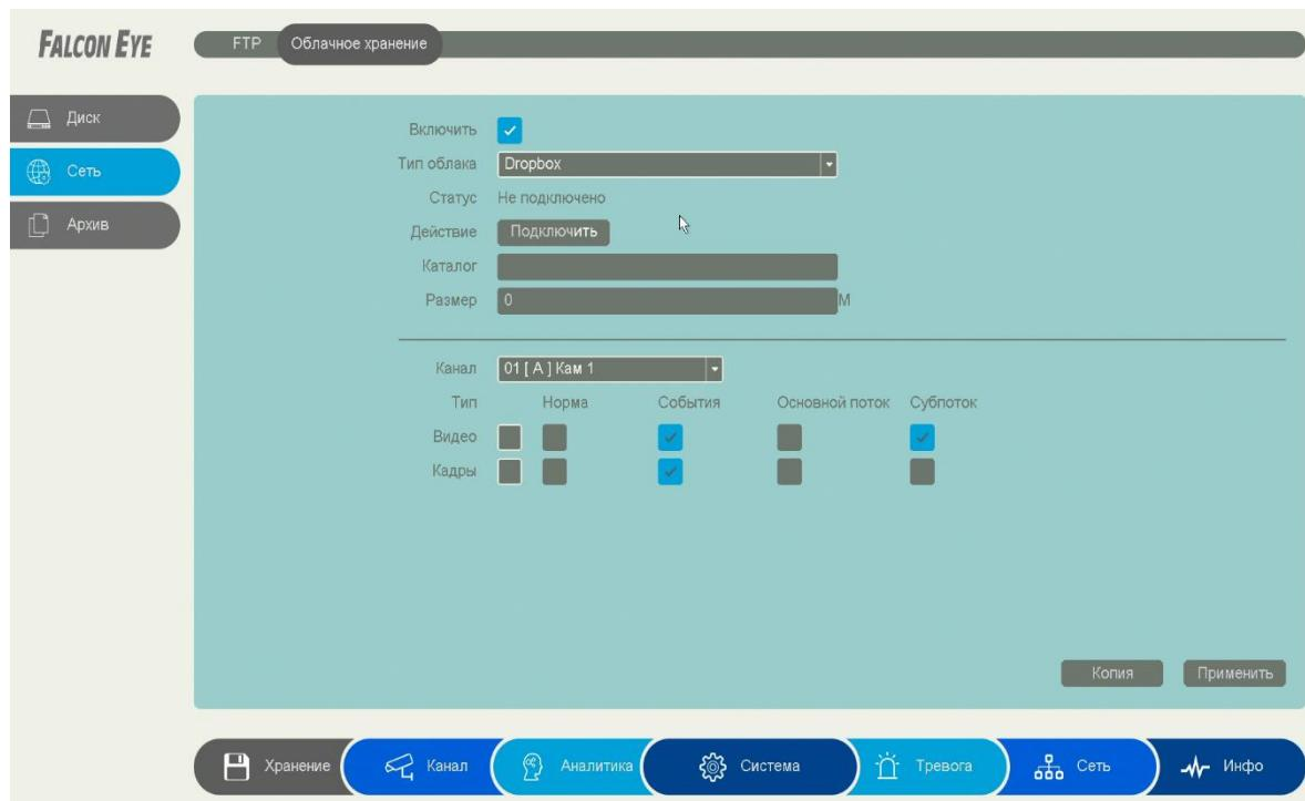
Для синхронизации с Dropbox поставьте галочку **Включить**, выберите **Тип облака – Dropbox** и нажмите кнопку **Подключение**.
