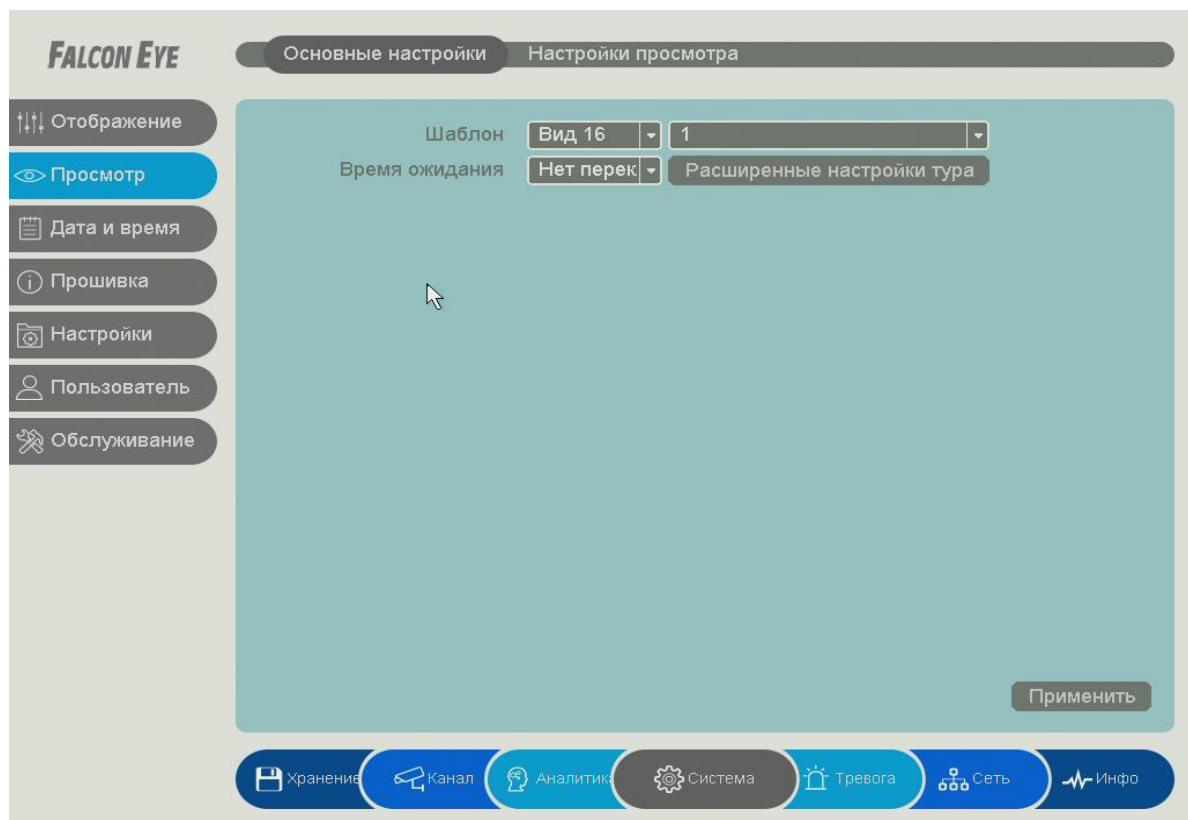
В данном меню можно настроить автоматическую смену через заданный интервал шаблона отображения на мониторе и выбрать отображаемые на данных шаблонах камеры.
