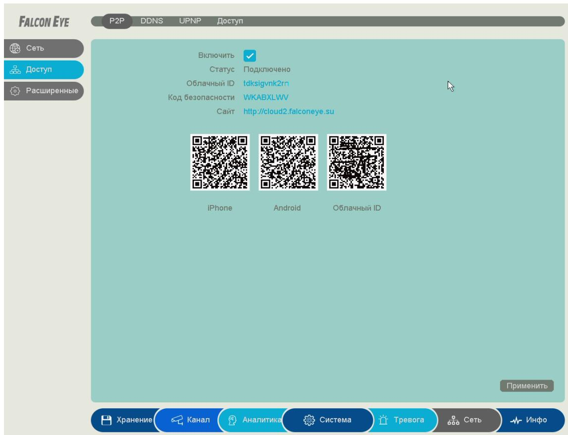
При включении этой функции видеорегистратор автоматически устанавливает соединение с сайтом <http://cloud2.falconeye.su>. При этом не требуется никаких настроек роутера, связанных с пробросом портов и наличием выделенного IP адреса.
