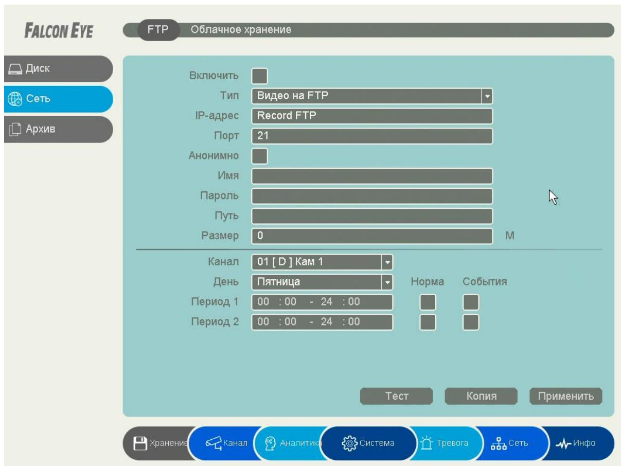
**Тип** – тип отправляемых на FTP сервер файлов. **Запись на FTP** – файлы видео в формате dav, **Снимки на FTP** – кадры в формате jpg.
