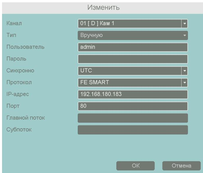
При нажатии иконки в верхнем поле появляется меню настроек подключения камеры. В меню выбирается канал регистратора, к которому подключается камера, тип подключения – вручную или автоматически, логин и пароль камеры.
