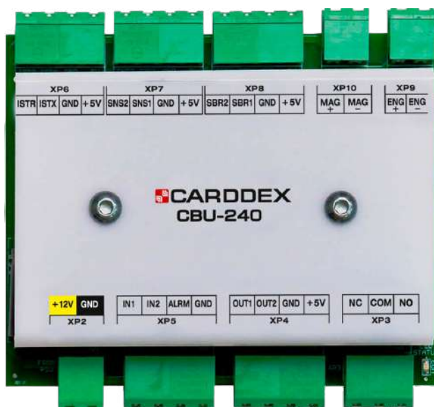
Рисунок 6.3.1 Контроллер управления турникетом «CBU-240»
