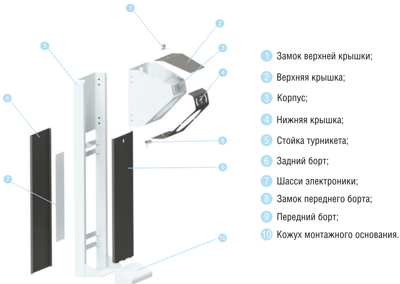
Рисунок 6.1.1 Устройство корпуса турникета
