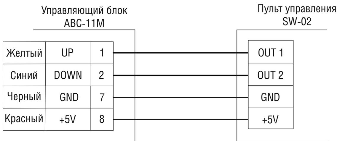
Рисунок 6.8.2 Схема подключения пульта дистанционного управления шлагбаумом «SW-02»
