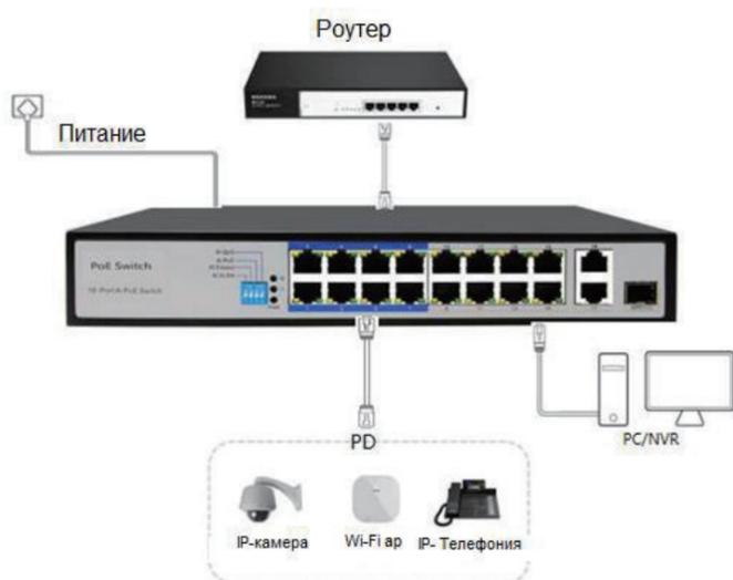
**Внимание** Когда коммутатор PoE подключен к рабочей станции, серверу, маршрутизатору или другому устройству Ethernet, длина сетевого кабеля не должна превышать 100 метров;
